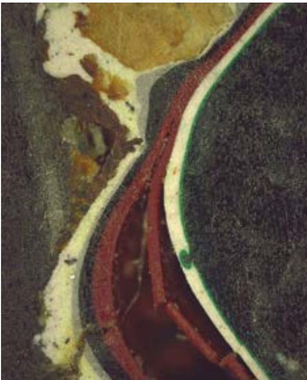
fig. 15. - Coupe stratigraphique sur les couches picturales prélevées sur la porte cochère.
